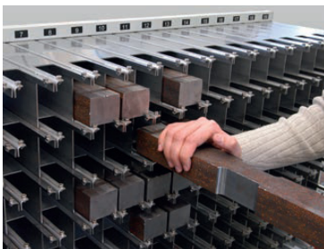
roboTest P 追加のセンサーと測定装置を組み込んだ、重い試験片の自動引張試験用です。 断面測定装置(右下)
