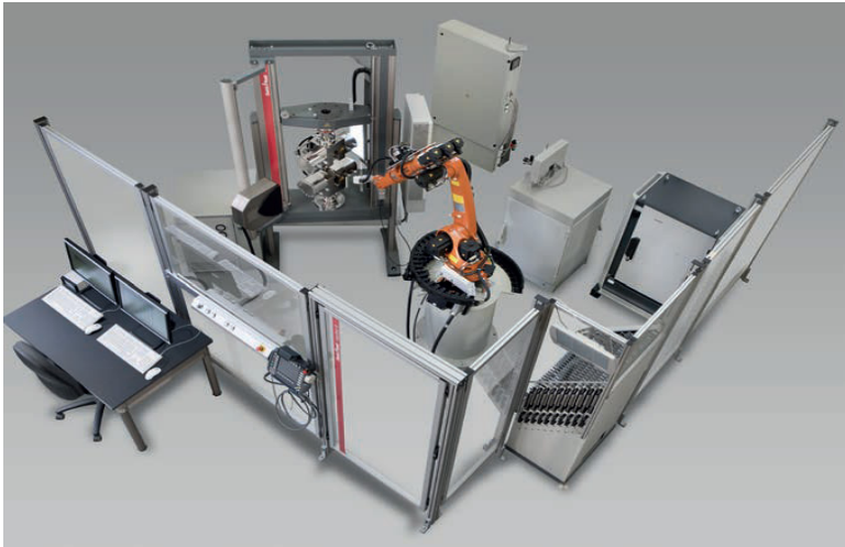
シートメタル、ロッド、鉄筋の自動引張試験 roboTest R
