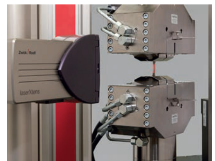
レーザー伸び計コンパクト 短い試験片用
