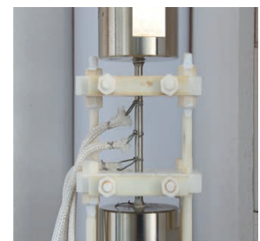
クリープ引張試験用ゲージ試験片 (伸び計と熱電対)
