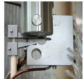
亀裂の拡大と亀裂の進行 ASTM E 1457 に準拠した測定
